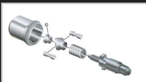
**JUMBO HAMMER** est utilisé dans les clés à chocs compactes AIRCAT et NITROCAT. Le marteau JUMBO permet à AIRCAT de fournir un couple élevé et une grande fiabilité dans ses plus petites clés à chocs. La cage est entraînée par le moteur qui entraîne le marteau JUMBO qui bascule sur les broches traversant la cage du marteau pour générer un coup fort pour chaque tour.
