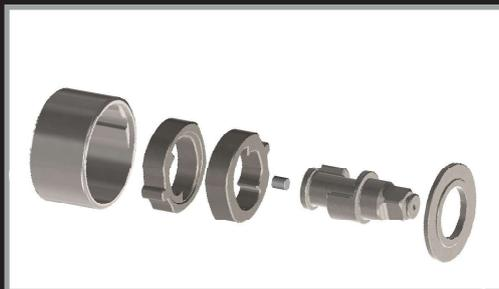
**TWIN HAMMER** est le mécanisme de clé à chocs le plus largement utilisé qui fournit une fréquence de soufflage rapide et un couple élevé. Ce mécanisme est le plus largement utilisé pour les clés à chocs AIRCAT 3/8", 1/2" et 3/4". La cage est entraînée par le moteur qui entraîne les marteaux jumeaux qui basculent sur les broches de marteau qui traversent la cage de marteau pour générer deux coups à chaque tour.
