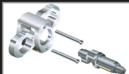
**PIN-LESS HAMMER** est utilisé dans les clés à chocs AIRCAT 1". Le mécanisme PIN-LESS a un entraînement plus positif et utilise moins de pièces mobiles, cette conception augmente la fiabilité pour les applications lourdes. Le grand marteau unique fournit une puissance de frappe forte pour atteindre un couple élevé rapidement. La cage est entraînée par le moteur qui entraîne le grand marteau unique pour générer un coup fort pour chaque tour.
